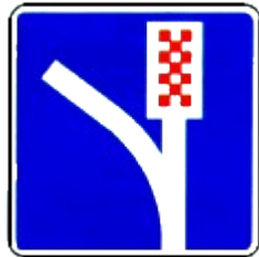
6.5 Полоса для аварийной остановки
